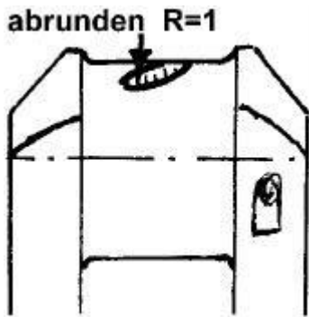
Abb. 2-12 Ausgebaute Kurbelwelle mit Ölaustrittsbohrungen
