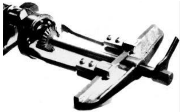
Abb. 2-13 Abziehen des Kegelrades von der Kurbelwelle mit Universalabzieher
