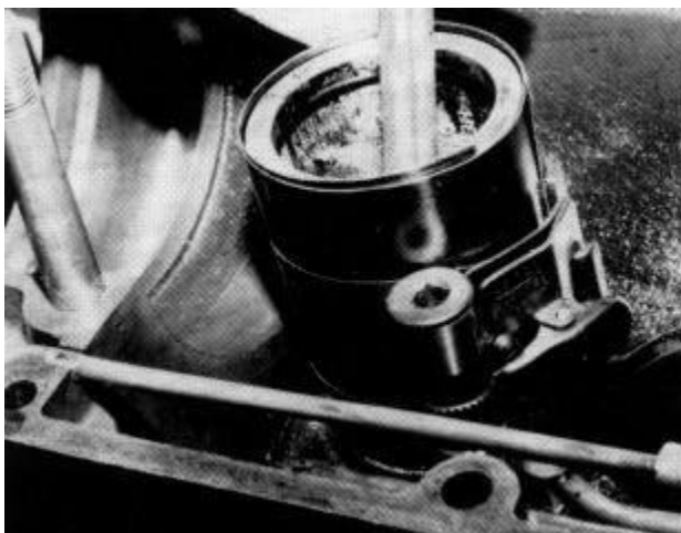
Abb. 2-20 Einbau des überholten Kolben
