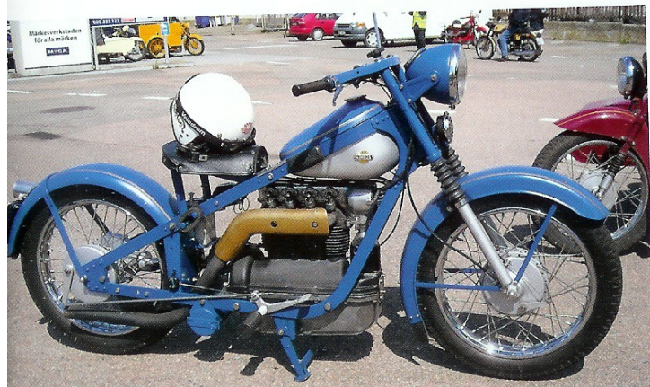
Detta är den "höga" framgaffeln som kom 1948. Längre fjädringsväg och bättre följsamhet. Skärmen följer hjulet till skillnad från tidigare.
