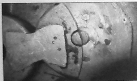
På 34'er gearkassen her (bemærk sommerfuglen vil venstre i billedet) er der monteret en blændplade der er nippet og tilpasset, så olietilstrømningen er afblændet.
