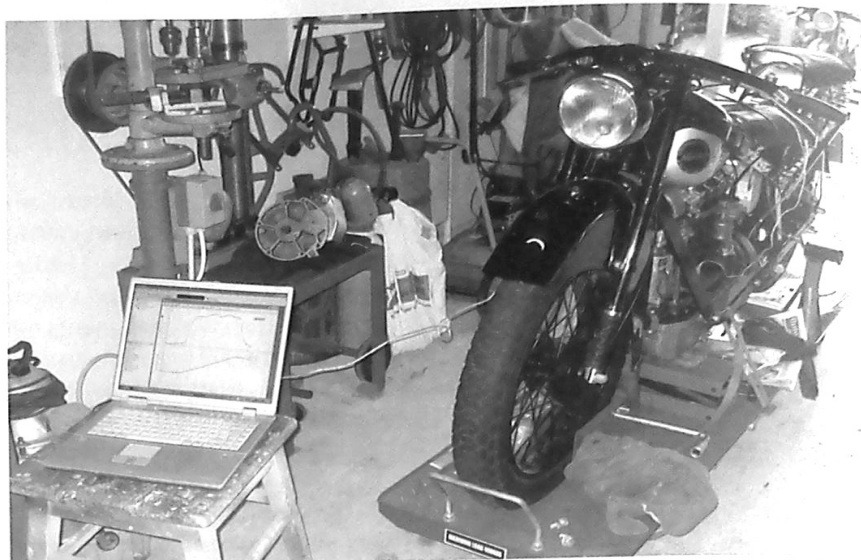
Dataopsamlingsudstyr monteret på Jens Bisbjergs 1934. Programmet Data Studio og dataopsamlingsmoduler fra Pasco kobler Nimbus'en på PC'en.
