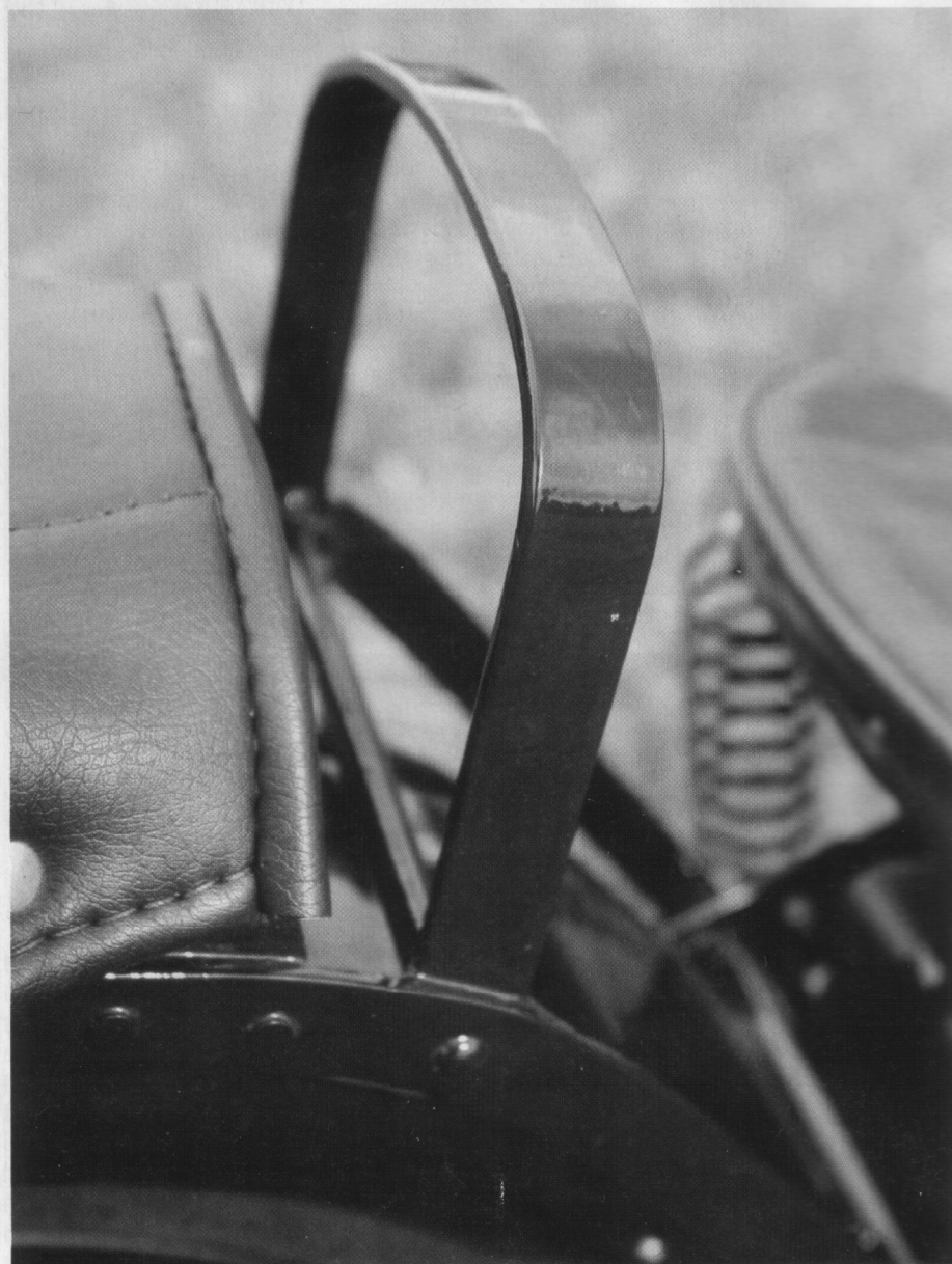
Helt i stil med resten af stelkonstruktionen, blev også bagsædepassagerens holdebjølle fremstillet af fladstål. Men da den var ubehagelig at holde på, sad den kun på de første 250 maskiner.
