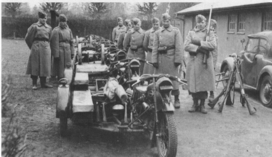
Kombinationen af en Nimbus med sidevogn og DISA's 20 mm Madsen kanon var meget effektiv. Det viste sig tydeligt den 9. april, da danske styrker bevæbnet med netop 20 mm kanonen kom i kamp med de tyske styrker. Den ekstra skærm på højre del af forgafflen skulle sikre og beskytte forlygten fra lufttrykket fra munden, der var så kraftig, at den ellers kunne smadre forlygteglasset.
