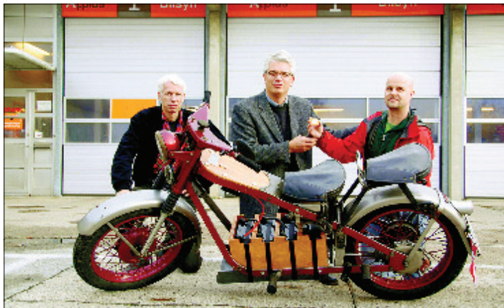
Axel Boisen (th) har udstyret sin Nimbus fra 1937 med vaskemaskinemotor og fire forbundne 12 volt batterier – og fået miljømærke af Applus Bilsyns egenindførte miljømærke. Kim Scholer, Nimbus Tidende (tv) har skrevet mere indgående om ombygningen.
