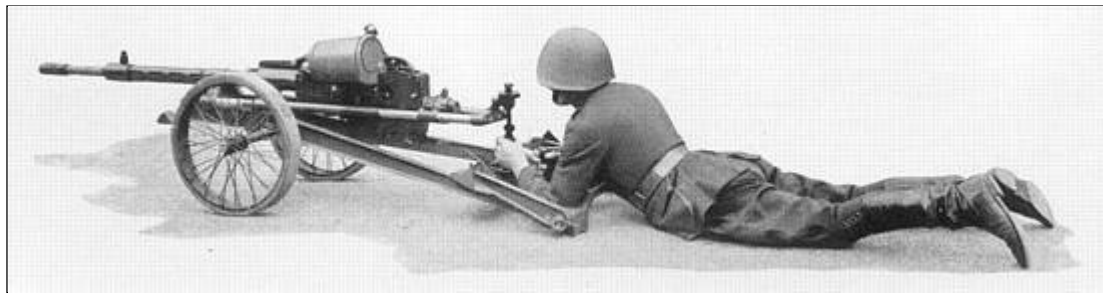
20 mm maskinkanon, opstillet til skydning fra transporthjulene. (Dansk Industri Syndikat). Fra Kilde 10 6 .
